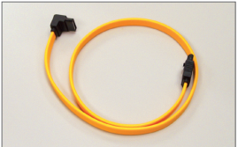
Końcówkę kabla SATA 3Gb/s (w kształcie litery L) podłącz do dysku twardego SATA.
