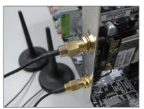
ステップ 4: 次に、信号が良好な場所にアンテナを移動します。
