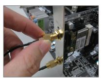
ステップ 3: 2 本のアンテナケーブルをそれぞれ GC-WIFI カードの アンテナ コネクタにピンと張るように接続します。
