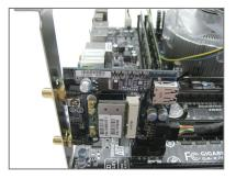
ステップ 1: GC-WIFI カードを PCI Express x1 スロットに装着します。 USB ケーブルの一方の端を GC-WIFI カードの USB コネクタに接続します。
