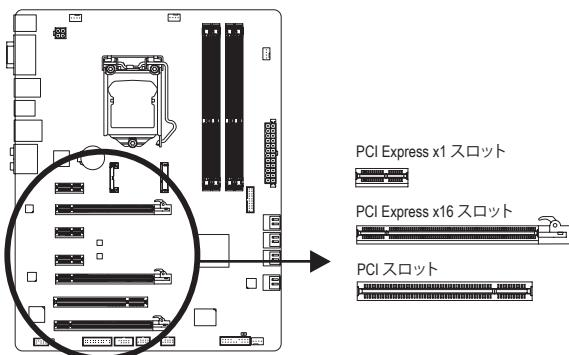
以下のステップに従って、拡張カードを拡張スロットに正しく取り付けてください。
