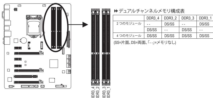
CPU制限により、デュアルチャンネルモードでメモリを取り付ける前に次のガイドラインをお読みください。
