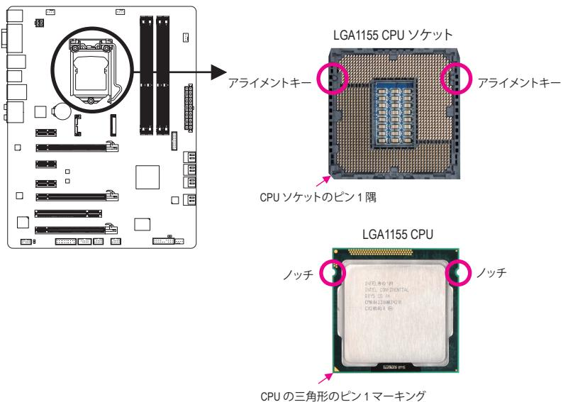
B. 以下のステップに従って、CPUをマザーボードのCPUソケットに正しく取り付けてください。
