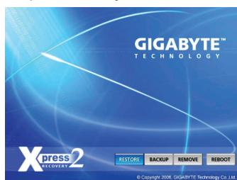
システムが故障した場合、**RESTORE** を選択してハードドライブへのバックアップを復元します。それまでバックアップが作成されていない場合、**RESTORE** オプションは表示されません。
