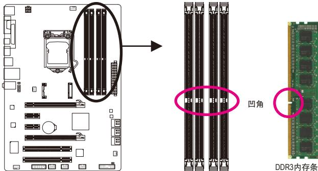
DDR3内存条上有一个凹角，只能以一个方向安装至内存条插槽内。请依下列步骤将内存条正确地安装于主板的内存插槽内。
