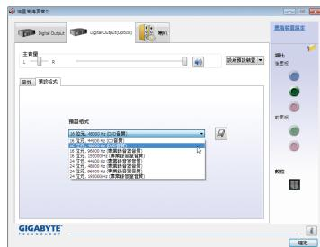
(注)若是使用主板后方面板的数字输出插座输出数字音频时,请至「Digital Output (Optical)」页面做进一步的设定;若是使用主板内接SPDIF输出插座(SPDIF\_O)输出数字音频时,请至「Digital Output」页面做进一步的设定。
