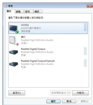
在Windows 7进入此选单，请在开始>控制台>硬件和音频>声音>播放，将「Intel(R)显示器音频」设为预设值。
