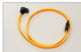
دقت داشته باشید که سمت L شکل کابل را به دیسک سخت متصل نمایید.
