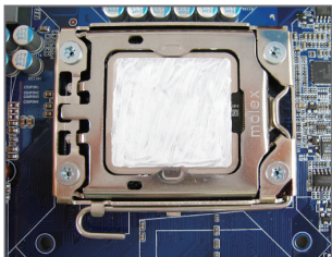
Fase 1: Applicare uno strato fine ed uniforme di grasso termico sulla superficie della CPU installata.
