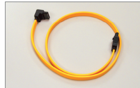
قم بتوصيل الطرف على شكل L من كابل SATA الخاص بالبيانات في القرص الصلب SATA الخاص بك
