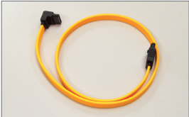
Подключите Г-образный разъем интерфейсного кабеля к жесткому SATA-диску.
