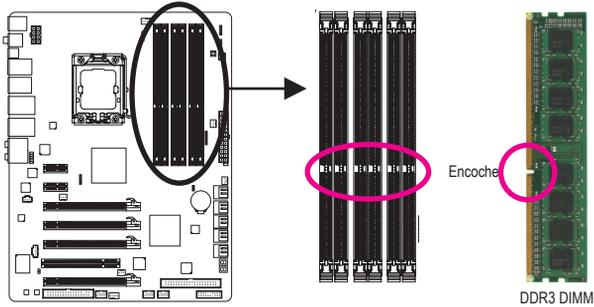
Un module de mémoire DDR3 possède une encoche pour être inséré dans un sens uniquement. Suivez les étapes ci-dessous pour installer correctement vos modules de mémoire dans les supports de la mémoire.
