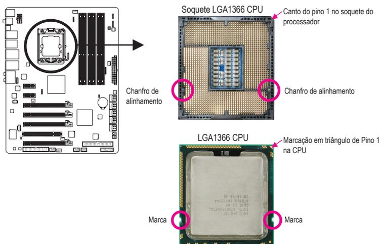
B. Siga os passos abaixo para instalar corretamente a CPU no soquete da CPU da placa mãe.
