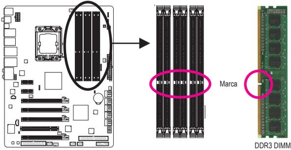
Um módulo de memória DDR3 possui uma marca de forma que só pode ser encaixado em uma posição. Siga as instruções abaixo para instalar de forma correta os seus módulos de memória nos slots de memória.
