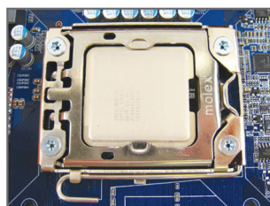
مرحله پنجم: پس از نصب صحیح پردازنده، با استفاده از دست، اهرم نگه دارنده سوکت را به پایین بیاورید و با دست دیگر به آرامی پوشش فلزی زوی سوکت را در جای خود قرار دهید.
