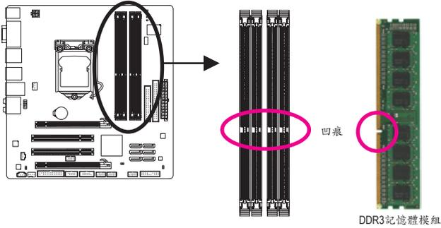
DDR3記憶體模組上有一個凹痕，只能以一個方向安裝至記憶體模組插槽內。請依下列步驟將記憶體模組正確地安裝於主機板的記憶體插槽內。
