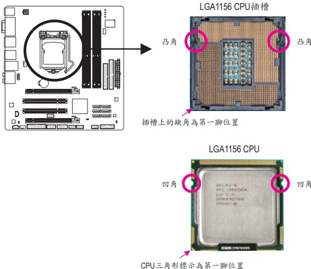
B. 請依下列步驟將CPU正確地安裝於主機板的CPU插槽內。
