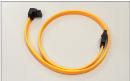
Conecte a extremidade com formato de "L" do cabo SATA 3Gb/s no seu HD SATA.
