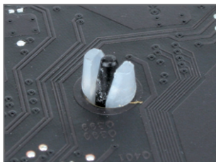
Fase 5: Dopo l'installazione, controllare la parte posteriore della scheda madre. Se i perni sono inseriti come mostrato nella precedente immagine, l'installazione è completata.
