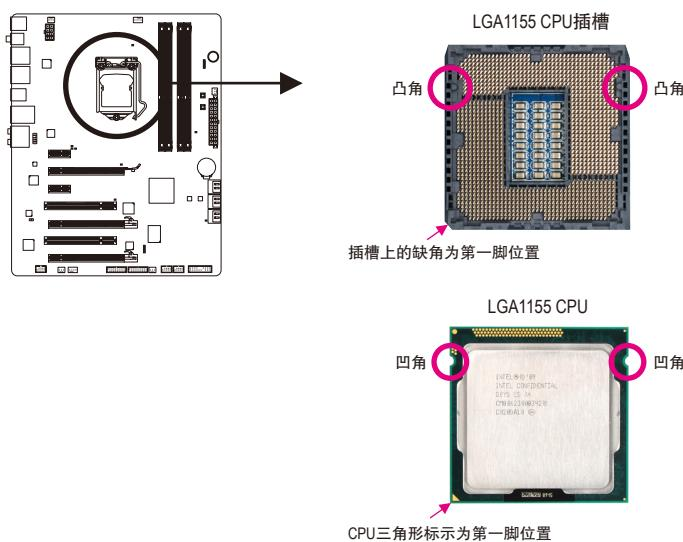
B. 请依下列步骤将CPU正确地安装于主板的CPU插槽内。
