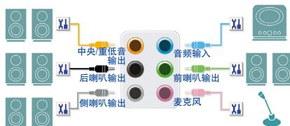
以四声道为例，若您将侧喇叭输出设备连接至中央/重低音输出的孔位，仅需经由音频软件将中央/重低音输出孔位重新定义成侧喇叭输出功能，即可正常使用。
