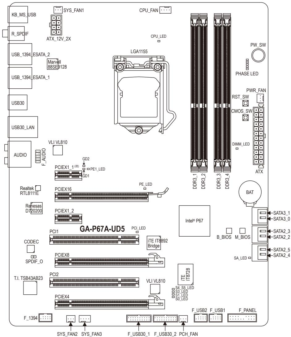
(注) 由于硬件限制, PCIEX1\_1插槽仅供较短的PCI Express x1适配卡使用。若要安装较长的适配卡, 请安装至其他插槽。
