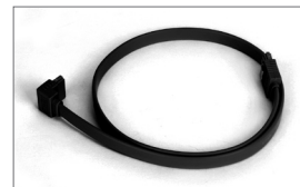
โปรดเชื่อมต่อปลายด้านที่มีรูป L ของสายเคเบิล SATA เข้ากับฮาร์ดไดรฟ์ SATA ของคุณ
