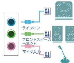
統合された HD (ハイディフィニション) オーディオにジャック再タスキング機能が搭載されているため、ユーザーはオーディオドライバを通して各ジャックの機能を変更することができます。
