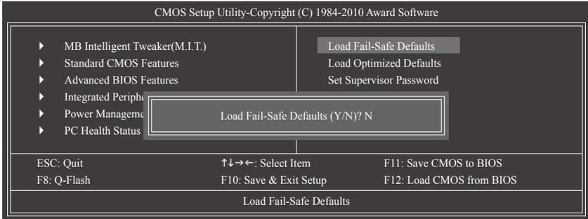
在此选项按<Enter>然后再按<Y>键，即可载入BIOS最安全预设值。如果系统出现不稳定的情况，可尝试载入最安全预设值。此设置值为最安全、最稳定的BIOS设置值。
