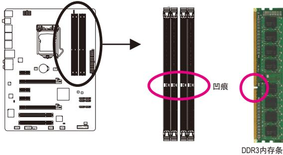
DDR3内存条上有一个凹痕，只能以一个方向安装至内存条插槽内。请依下列步骤将内存条正确地安装于主板的内存插槽内。
