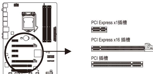
请依下列步骤将适配卡正确地安装于主板的适配卡插槽内：
