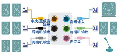
以四声道为例，若您将侧喇叭输出设备连接至中央/重低音输出的孔位，仅需经由音频软件将中央/重低音输出孔位重新定义成侧喇叭输出功能，即可正常使用。
