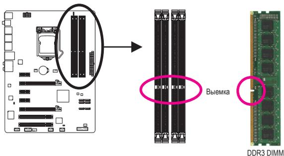
На печатной плате любого модуля ОЗУ DDR3 присутствует специальная выемка, которая облегчает процедуру установки. Приведенное далее пошаговое руководство поможет корректно установить модули в соответствующие DIMM-разъемы на системной плате.
