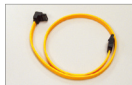
لطفا اتصال دهنده L شکل کابل SATA 3Gb/s را به هارددیسک خود متصل کنید.
