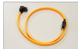
โปรดเชื่อมต่อปลายด้านที่มีรูป L ของสายเคเบิล SATA 3Gb/s เข้ากับฮาร์ดไดรฟ์ SATA ของคุณ
