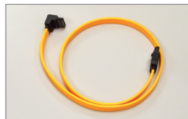
Korówkę kabla SATA 3Gb/s (w kształcie litery L) podłącz do dysku twardego SATA.
