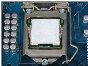
Fase 1: Applicare uno strato fine ed uniforme di grasso termico sulla superficie della CPU installata.
