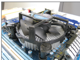
Fase 3: Collocare il dissipatore sopra la CPU, allineando i quattro perni con i quattro fori della scheda madre. Premere i perni diagonalmente.
