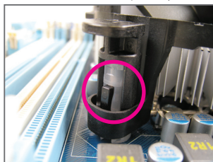
Fase 4: Si deve sentire uno "scatto" quando si preme su ciascun perno. Assicurarsi che il perno maschio e femmina siano uniti saldamente. (Fare riferimento al manuale del dissipatore di calore CPU per istruzioni su come installare il dissipatore.)
