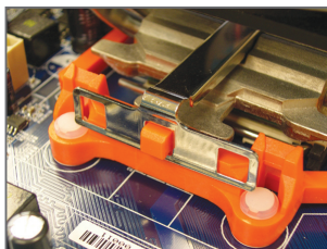
Fase 3: Agganciare la molletta del dissipatore di calore della CPU alla linguetta di fissaggio su un lato del telaio di montaggio. Sull'altro lato, premere verso basso sul dissipatore di calore della molletta della CPU per agganciarla alla linguetta di fissaggio sul telaio di montaggio.
