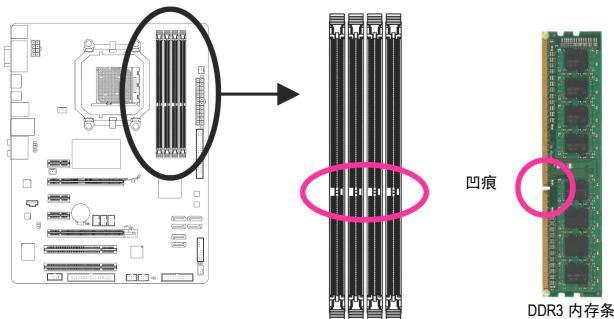
DDR3 内存条上有一个凹痕, 只能以一个方向安装至内存条插槽内。请按照下列步骤将内存条正确地安装于主板的内存插槽内。
