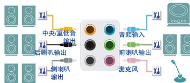
以四声道为例，若您将后喇叭输出设备连接至中央/重低音输出的孔位，仅需经由音频软件将中央/重低音输出孔位重新定义后喇叭输出功能，即可正常使用。
