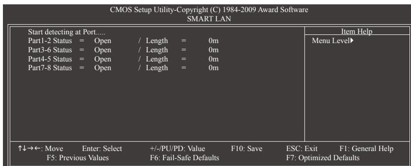
本主板具备网线检测功能，帮助用户可以在BIOS中确认目前网络连接情况是否正常，若线路故障时也可报告故障位置。请参考以下说明：
