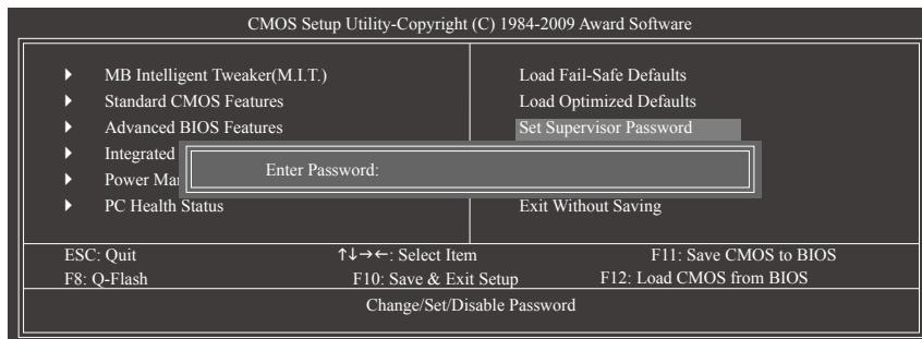
在此选项按<Enter>键可开始输入密码。最多可以输入8个字符，输入完毕后按<Enter>键，BIOS会要求再输入一次以确认密码。
