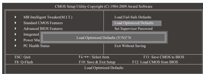
在此选项按<Enter>然后再按<Y>键，即可载入BIOS出厂预设值。执行此功能可载入BIOS的最佳化预设值。此设置值较能发挥主板的运行性能。在更新BIOS或清除CMOS数据后，请务必执行此功能。
