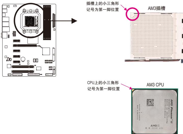
B. 请依下列步骤将CPU正确地安装于主板的CPU插槽内。
