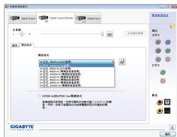
(注) 若是使用主板后方面板的数字输出插座输出数字音频时，请至「DigitalOutput (Optical)」页面做进一步的设置；若是使用主板内接S/PDIF 输出插座(SPDIF\_OUT)输出数字音频时，请至「Digital Output」页面做进一步的设置。
