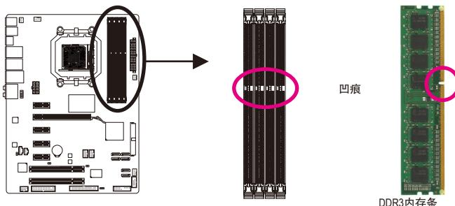
DDR3内存条上有一个凹痕，只能以一个方向安装至内存条插槽内。请依下列步骤将内存条正确地安装于主板的内存插槽内。
