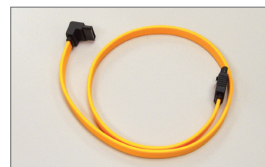
لطفاً اتصال دهنده L شکل کابل SATA 3Gb/s را به دیسک سخت خود متصل کنید.
