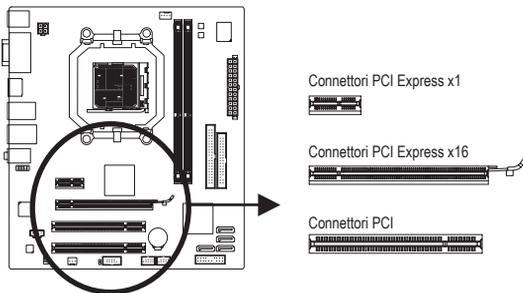
Attenersi alle fasi che seguono per installare la scheda d'espansione nel suo alloggiamento.
