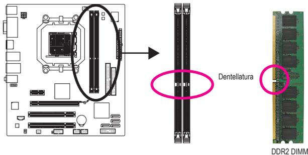
I moduli DDR2 hanno una dentellatura, quindi può essere inserito solamente in una direzione. Attenersi alle fasi che seguono per installare correttamente i moduli di memoria negli alloggi.
