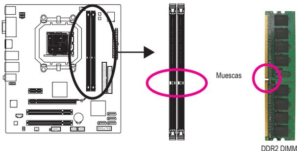
Un módulo de memoria DDR2 tiene una muesca, de forma que solamente puede encajarse en una posición. Siga los pasos que se indican a continuación para instalar correctamente los módulos de memoria en sus zócalos.
