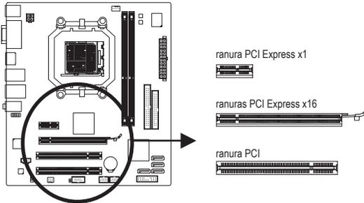
Siga los pasos que se indican a continuación para instalar correctamente la tarjeta de expansión en la ranura de expansión.
