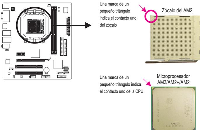
B. Siga los pasos que se indican a continuación para instalar correctamente el microprocesador en su zócalo situado en la placa base.
