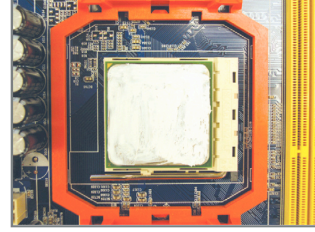
خطوة (1): قم بإضافة طبقة مناسبة من المعجون الحراري Thermal grease أعلى سطح المعالج.
