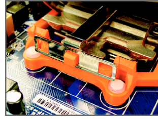
خطوة (3): قم بتركيب مشبك مبرد المعالج في هيكل التركيب البلاستيكي، ثم اضغط على مشبك مبرد المعالج من الجهة الأخرى ليتمكنك تركيبه في هيكل التركيب البلاستيكي.
