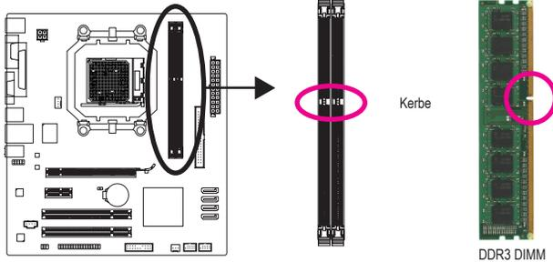
Ein DDR3 Arbeitsspeichersmodul hat eine Kerbe, so dass es nur in eine Richtung einpassen kann. Folgen Sie den nachstehenden Schritten, um Ihre Arbeitsspeichersmodule richtig in die Arbeitsspeichersockeln einzubauen.
