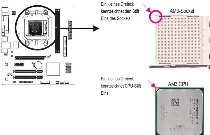
B. Folgen Sie den nachstehenden Schritten, um die CPU richtig in den CPU-Sockel am Motherboard einzubauen.
