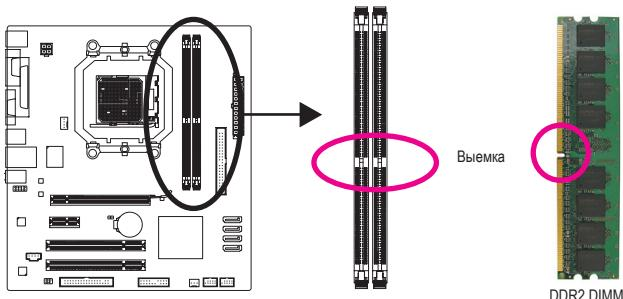
На печатной плате любого модуля ОЗУ DDR2 присутствует специальная выемка, которая облегчает процедуру инсталляции. Приведенное далее пошаговое руководство поможет корректно установить модули в соответствующие DIMM-разъемы на системной плате.
