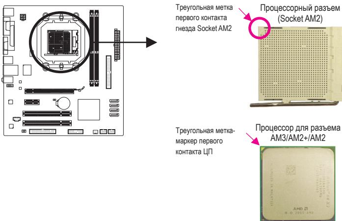
В. Пошаговая инструкция по установке ЦП на системную плату.
