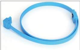
请将SATA 排线的L型接头连接至SATA硬盘。
