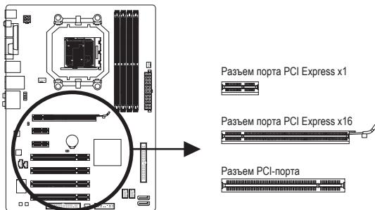
Приведенная далее пошаговая инструкция поможет корректно установить плату расширения в соответствующий разъем на системной плате.
