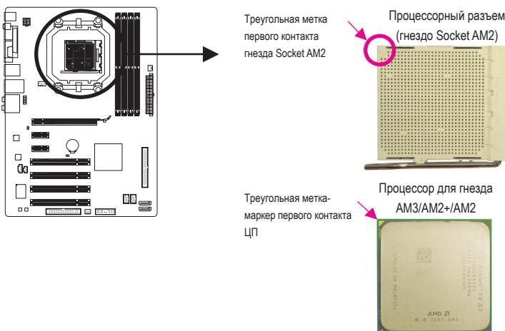
В. Пошаговая инструкция по установке ЦП на системную плату.
