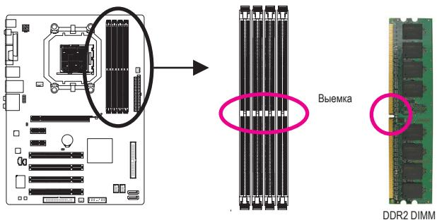
На печатной плате любого модуля ОЗУ DDR2 присутствует специальная выемка, которая облегчает процедуру инсталляции. Приведенное далее пошаговое руководство поможет корректно установить модули в соответствующие DIMM-разъемы на системной плате.
