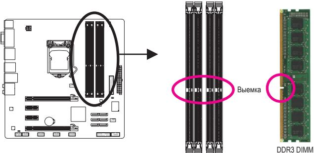
На печатной плате любого модуля ОЗУ DDR3 присутствует специальная выемка, которая облегчает процедуру инсталляции. Приведенное далее пошаговое руководство поможет корректно установить модули в соответствующие DIMM-разъемы на системной плате.
