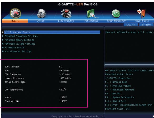
Esta seção fornece informações sobre a versão da BIOS, base do clock do processador, a frequência da CPU, a frequência da memória, tamanho total da memória, temperatura da CPU, Vcore, e tensões da memória.
