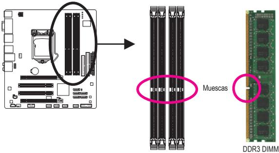
Un módulo de memoria DDR3 tiene una muesca, de forma que solamente puede encajarse en una posición. Siga los pasos que se indican a continuación para instalar correctamente los módulos de memoria en sus zócalos.
