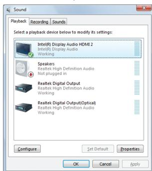
En Windows Vista, seleccione Start (Inicio) > Control Panel (Panel de control) > Sound (Sonido) > Playback (Reproducir), establezca Intel(R) Display Audio HDMI 2 (HDMI 2 para audio y vídeo Intel(R)) en el dispositivo de reproducción predeterminado.
