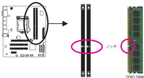
DDR3 メモリモジュールにはノッチが付いているため、一方向にしかフィットしません。以下のステップに従って、メモリソケットにメモリモジュールを正しく取り付けてください。
