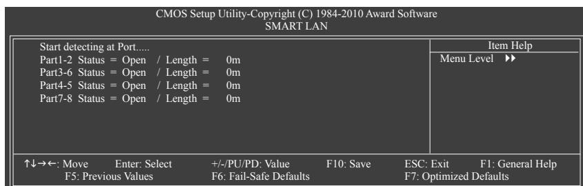
このマザーボードは、付属の LAN ケーブルの状態を検出するために設計されたケーブル診断機能を組み込んでいます。この機能は、配線問題を検出し、障害またはショートまでのおおよその距離を報告します。LAN ケーブルの診断については、以下の情報を参照してください:
