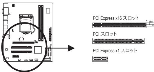
以下のステップに従って、拡張スロットに拡張カードを正しく取り付けてください。
