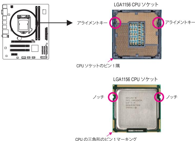
B. 以下のステップに従って、CPUをマザーボードのCPUソケットに正しく取り付けてください。
