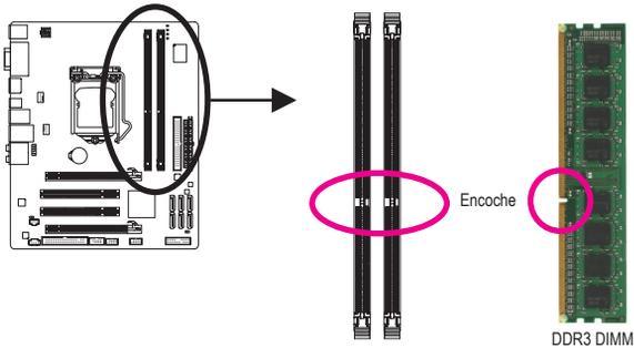
Un module de mémoire DDR3 possède une encoche pour être inséré dans un sens uniquement. Suivez les étapes ci-dessous pour installer correctement vos modules de mémoire dans les supports de la mémoire.
