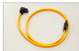
لطفاً اتصال دهنده L شکل کابل SATA 3Gb/s را به هارد دیسک خود متصل کنید.
