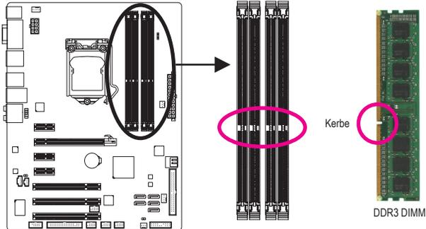
Ein DDR3 Arbeitsspeichermodul hat eine Kerbe, so dass es nur in eine Richtung einpassen kann. Folgen Sie den nachstehenden Schritten, um Ihre Speichermodule richtig in die Speichersteckplätze einzubauen.
