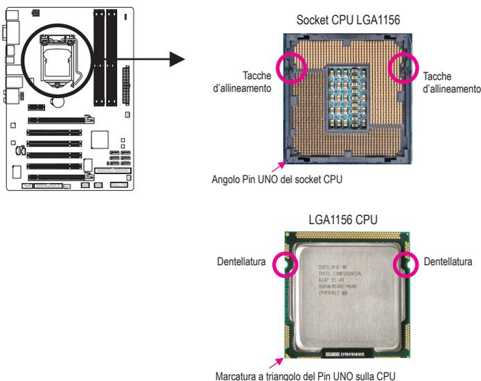
B. Attenersi alle fasi che seguono per installare correttamente la CPU sul socket CPU della scheda madre.
