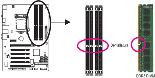
I moduli DDR3 hanno una dentellatura, quindi può essere inserito solamente in una direzione. Attenersi alle fasi che seguono per installare correttamente i moduli di memoria negli socket.
