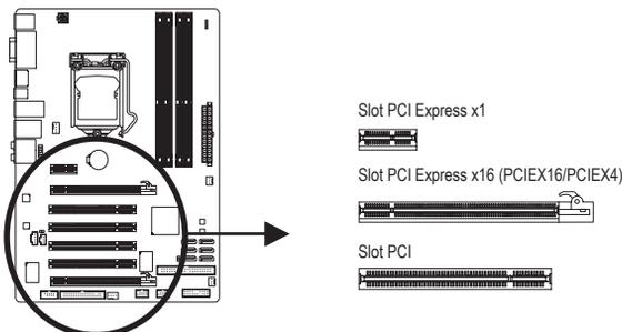
Attenersi alle fasi che seguono per installare la scheda d'espansione nel suo slot.
