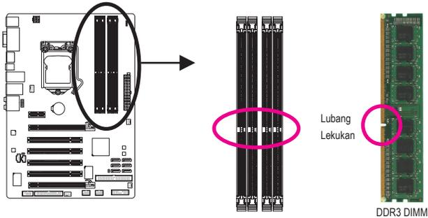
Sebuah modul memori DDR3 tidak memiliki lubang lekukan, jadi modul ini hanya cocok dipasang pada satu arah saja. Ikutilah langkah-langkah di bawah ini untuk memasang modul-modul memori pada socket memornya dengan benar.
