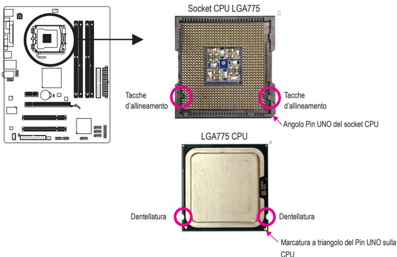
B. Attenersi alle fasi che seguono per installare correttamente la CPU sul socket CPU della scheda madre.
