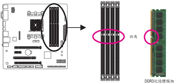
DDR3記憶體模組上有一個凹角，只能以一個方向安裝至記憶體模組插槽內。請依下列步驟將記憶體模組正確地安裝於主機板的記憶體插槽內。
