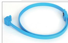
Końcówkę kabla SATA (w kształcie litery L) podłącz do dysku twardego SATA.
